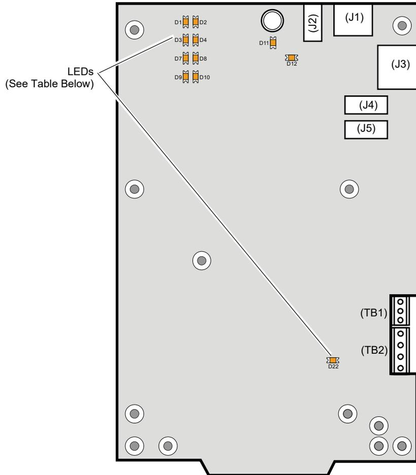
**Figure 2.6 MODBUS-GW LEDs**
