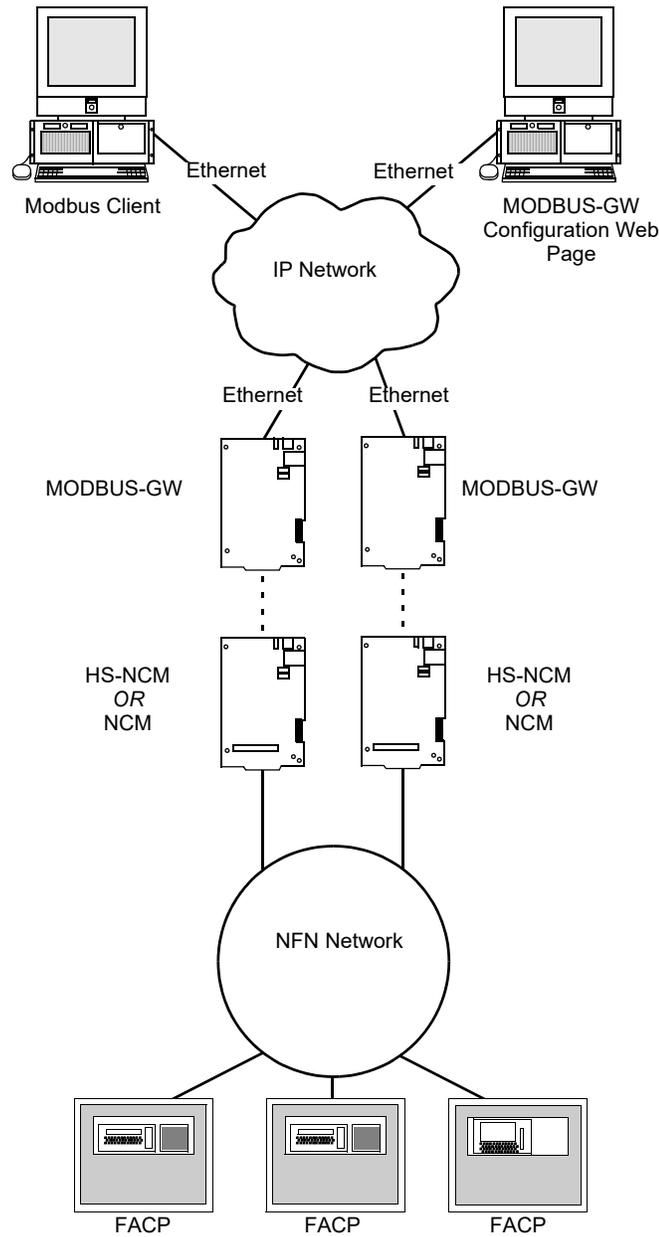
**Figure 1.3 Redundant Modbus Gateways**
